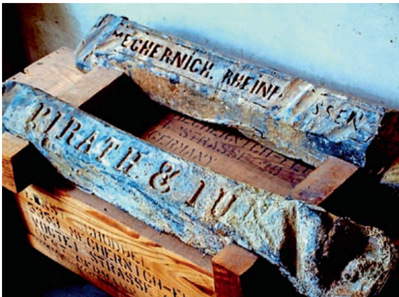
Abb. 6: Entsilberte Bleibarren der Fa. „Pirath & Jung“, um 1870, geborgen vor der Küste von Virginia (USA) Foto: Norbert Knauf, 2008; Bergbaumuseum Mechernich
