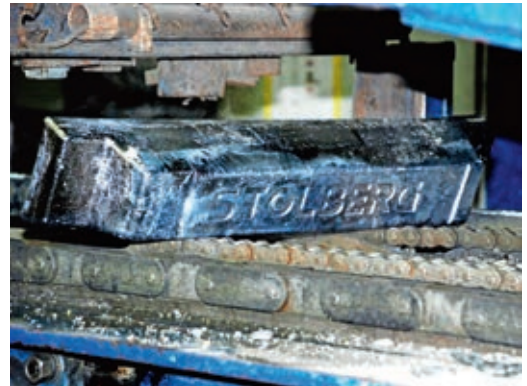
Abb. 7: Blei-Barren, Bleigehalt 99,99 Gew. %, Stolberger Bleihütte Foto: Norbert Knauf, 2008
