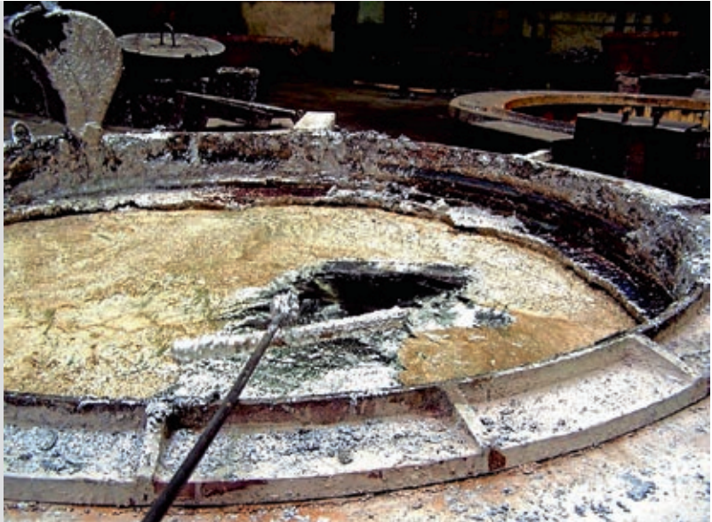
Abb. 5: Abheben von Zinkschaum, Stolberger Bleihütte Foto: Norbert Knauf, 2008
